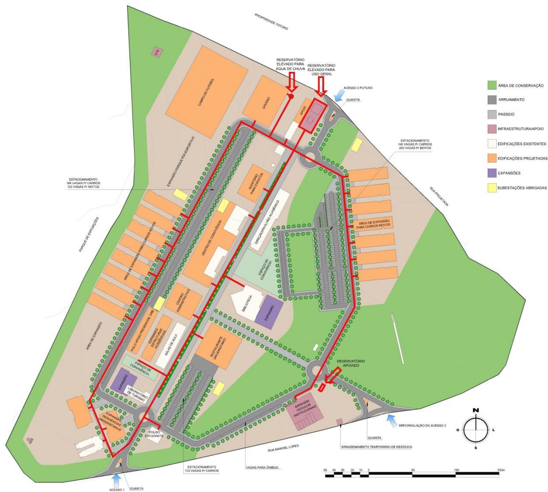
Figura 36 – Esquema da diretriz do sistema de abastecimento de água do campus de Currais Novos – 2014.
